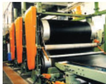
Wichtige Bestandteile einer Anlage zur Herstellung von Kautschukbahnen (v. l. n. r.): Extruder mit Breitspritzkopf, Kalender, Doublirstation und Kühlstuhl
