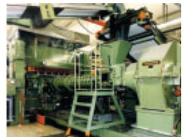
Roller Head-Anlage zur Produktion von Kautschukbahnen
